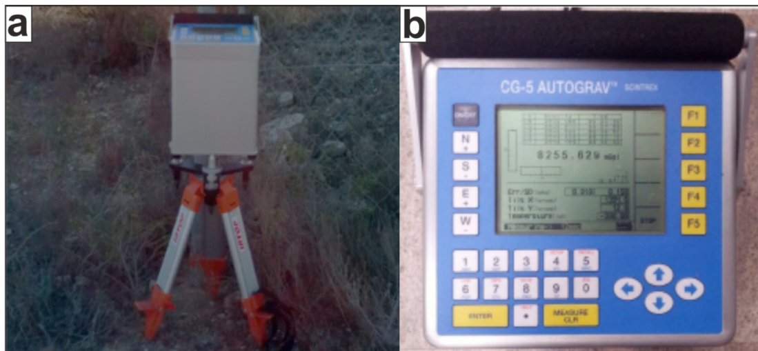
Figura 2. Gravímetro Scintrex Autograv CG-5 en posición de medida sobre trípode (a) e imagen de la pantalla del equipo (b).
